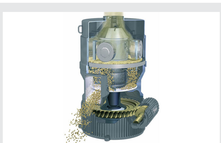
Figura 2. Peletizadora de matriz plana y rodillos giratorios Fuente: Ortiz, 2008
